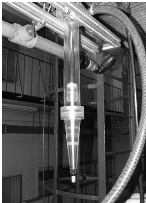
Rys. 2. Hydrocyklon typu A wykonany ze szkła organicznego
