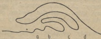
Fig. 2. a, b — Faldy miejscowe; c, d — płaszczowiny.
