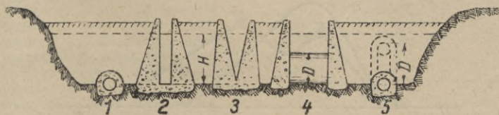
Fig. 105. Typy upustów w samoczynnych zbiornikach powodziowych.
