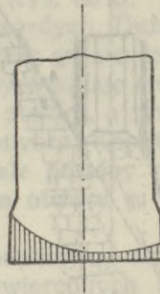
Rys. 79. Zużycie szczęk dłuta przy znacznym skrzywieniu otworu.
