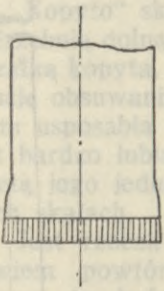
Rys. 77. Prawidłowe zużycie szczęk dłuta.
