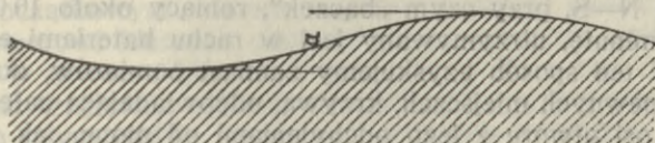
Rys. 88. Krzywa wskazująca miarę odchylenia osi otworu od pionu.
