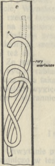
Rys. 105. Pogięte żerdzie tkwiące w rurach.
