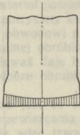
Rys. 78. Zużycie szczęk dłuta przy poczynającym się skrzywieniu otworu.
