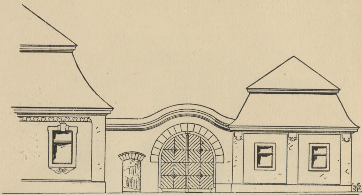
Część domu małomiasteczkowego o dachu polskim t. zw. „łamanym“, z budyneczkiem przybramnym.
