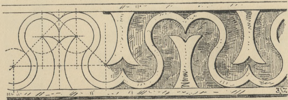
Pas wstęgowy o linii „sercowatej”, z oznaczeniem sposobu wykreślenia tejże na zasadzie kół zbliżonych.
