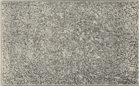
Kw. azot. Ryc. 17. pow. = 500 Sorbil. Stal C.
