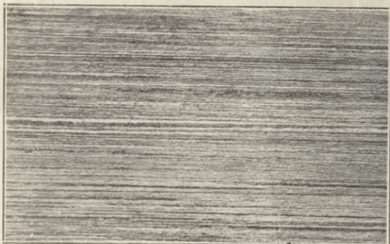
Oberhoffer. Ryc. 10. pow. = 5 Struktura pierwotna, jednokierunkowa — wyraźna. Stal C.
