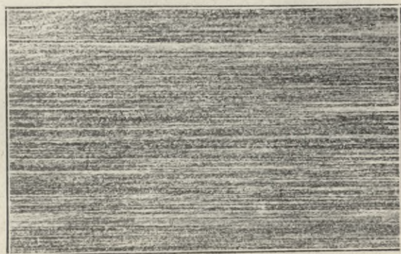
Oberhoffer. Ryc. 8. pow. = 5 Struktura pierwotna, jednokierunkowa — widoczna. Stal A.
