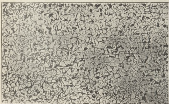
Kw. azol. Ryc. 12. pow. = 100 Struktura drobnoziarnista. Ferryt i perlit na grani- cach ziarn. Stal A.
