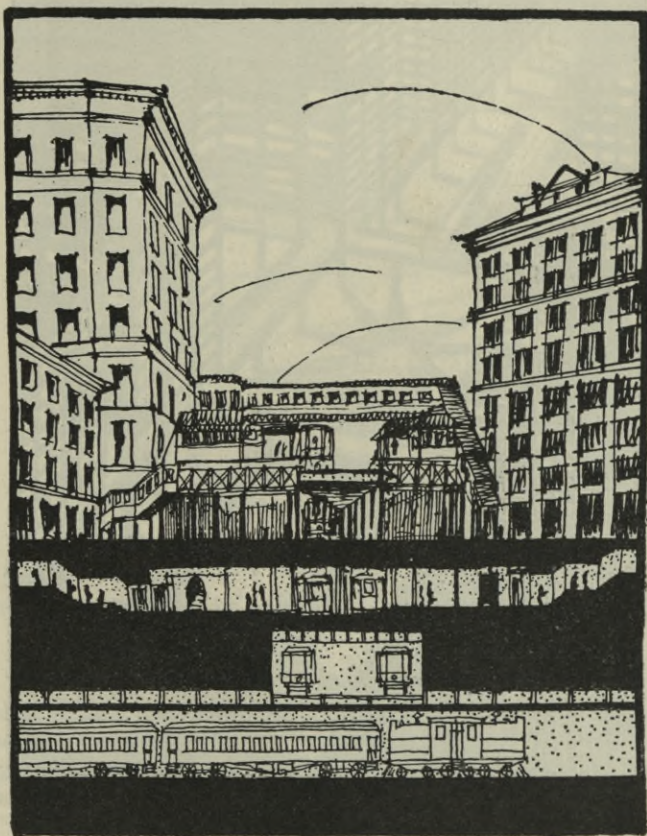
Rys. 16. Pięć pięter komunikacyjnych na skrzyżowaniu szóstej avenue z 33. ulicą w Nowym Yorku.
