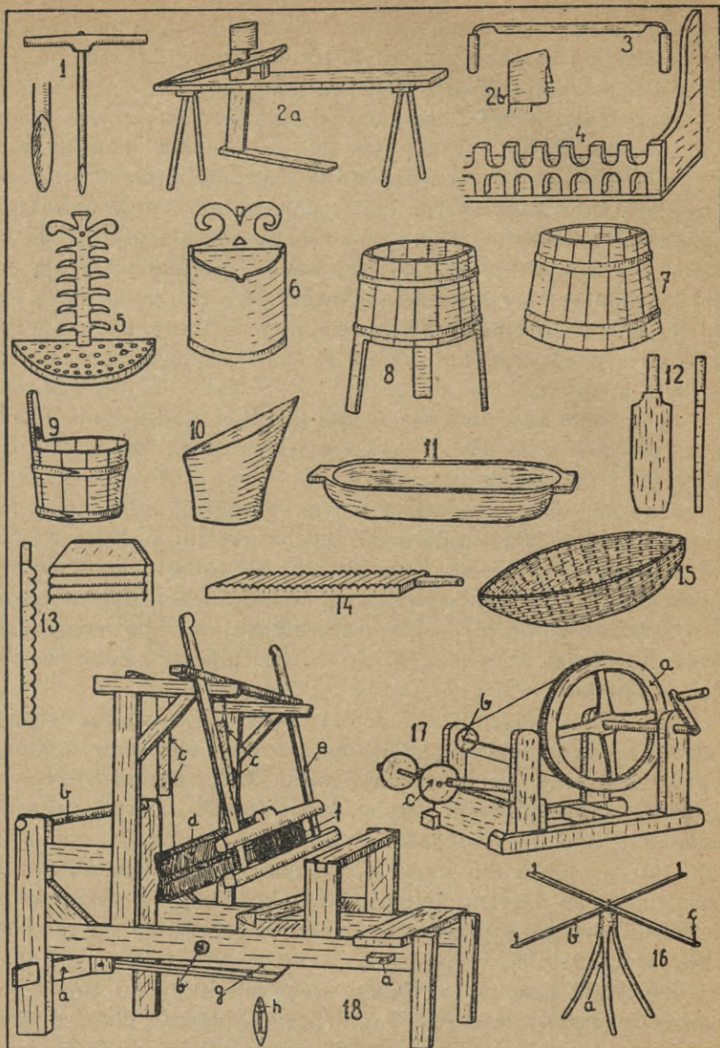
Tablica III. 1 świder, Komańcza; 2 a stółek stolarsko-bednarski, Wołosate; 2 b zakończenie części przytrzymującej w stolku stolarskim, Tyrawa S.; 3 dwuręczny strug do drzewa, Komańcza; 4 półka na miski, Prełuki; 5 łyżnik, Prełuki; 6 solniczka, Prełuki; 7 dziezka do zaczyniania ciasta, Wola Michowa;
