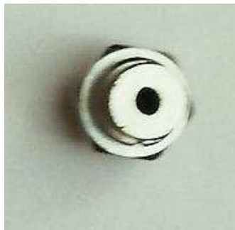
Rys.1. Tulejki o współosiowych otworach wymagających tępienia ostrych krawędzi
