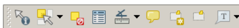
Rys. 12. Pasek narzędzi Atrybuty, kolejno: Informacje o obiekcie, Wybierz jeden obiekt, Zlikwiduj zaznaczenie obiektów, Otwórz tabelę atrybutów, Pomiar kąta, Podpowiedzi na mapie, Nowa zakładka, Pokaż zakładki, Opis tekstowy
