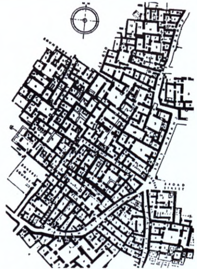
Ryc. 9. Plan miasta Ur w Mezopotamii z ok. 2000 r. p.n.e. z charakterystycznym przebiegiem skośnych ulic dostosowanych do spadku terenu [7]
