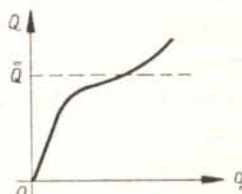
Rys. 48. i Rys. 49. Przykłady zależności uogólnionej siły od uogólnionego przemieszczenia przy uwzględnieniu odkształceń sprężystych i zmian geometrii układu
