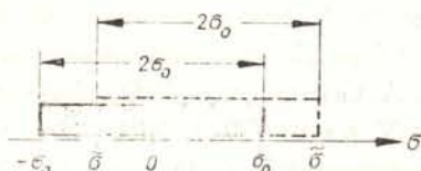
Rys. 82. Model kinematyczny idealnego efektu Bauschingera
