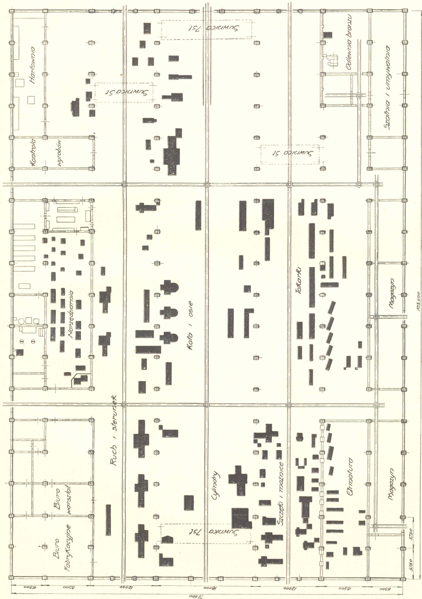
ROZMIESZCZENIE MASZYN W WARSZTACIE MECHANICZNYM
