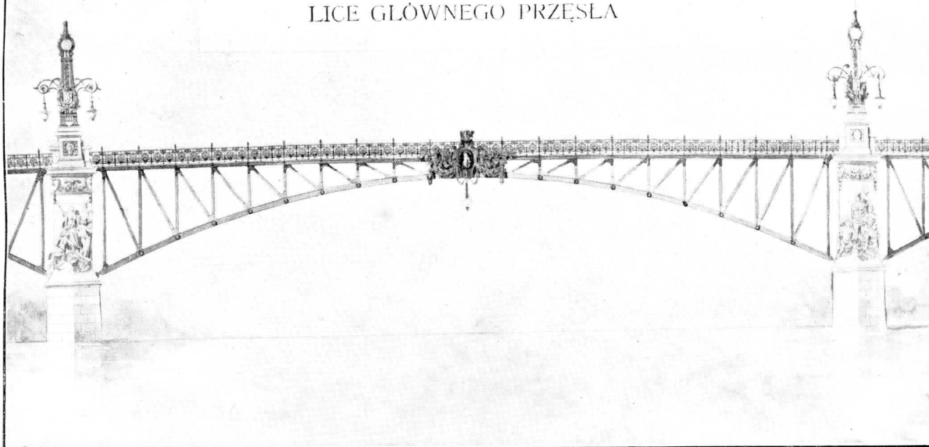
ILUSTR. 50. PIERWOTNY PROJEKT GŁÓWNEGO PRZĘŚLA MOSTU.
