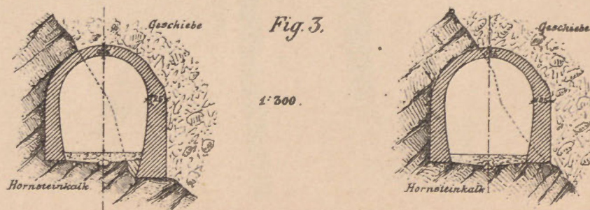
Tunnelring gegen Grundten
