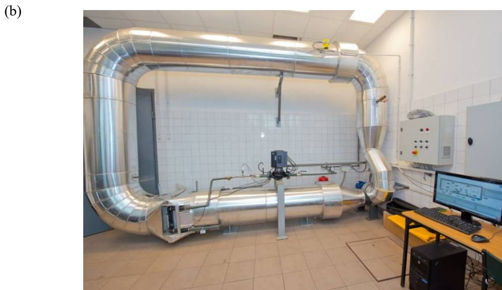
Rys. 4.1. Stanowisko do badań akumulacyjnego systemu ogrzewania budynku ze źródłem ciepła w postaci ogrzewacza akumulacyjnego o nowej konstrukcji:
