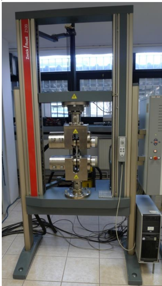
Rys. 3.10 Maszyna wytrzymałościowa. Źródło: badania własne
