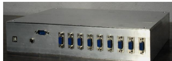
Rys. 22. a) Widok ogólny prototypu przyrządu pomiarowego. 1- płyta zewnętrzna przyrządu mocowana do nadwozia pojazdu, 2- płyta wewnętrzna przyrządu mocowana do koła pojazdu, 3- listwa pomiarowa czujnika optycznego. b) Zestaw przetworników analogowo- cyfrowych.
