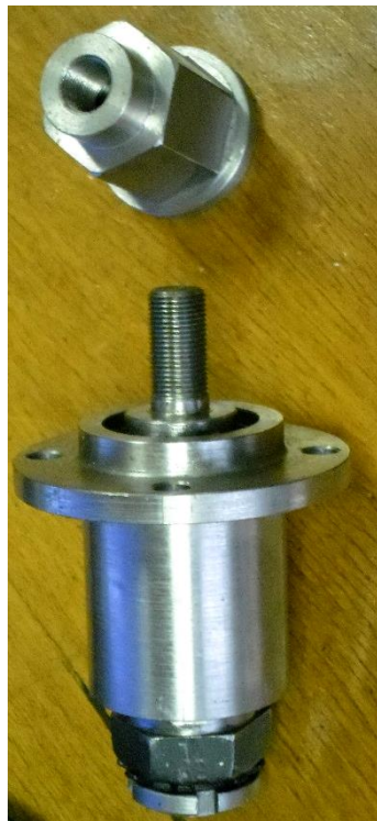
Rys. 19. Ułożyskowana piasta, za pomocą której mocowana jest wewnętrzna płyta przyrządu. Widoczna jest również nakrętka łącząca piastę z osią piasty koła badanego pojazdu.
