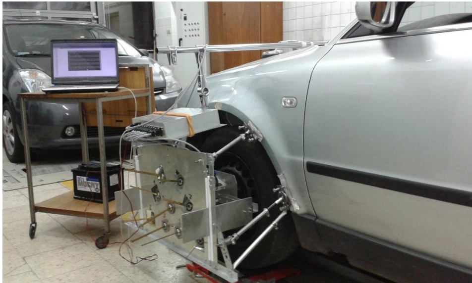
Rys. 97. Zbliżenie na lewe koło samochodu Volkswagen Passat z zamocowany przyrządem do pomiaru liniowych oraz kątowych przemieszczeń koła względem nadwozia. Widoczne są uchwyty, za pomocą których przyrząd został unieruchomiony względem nadwozia, jak również ramiona prowadzące, których zadaniem było odebranie płycie wewnętrznej przyrządu możliwości obrotu względem osi y pokrywającej się z osią obrotu koła.
