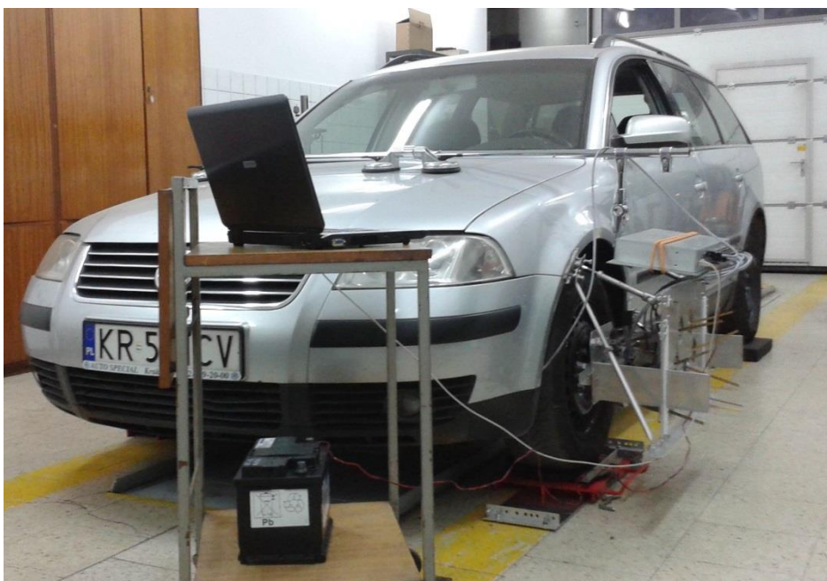
Rys. 96. Przygotowany do pomiarów stanowiskowych samochód Volkswagen Passat B5 w widoku ogólnym. Widoczny jest prototypowy przyrząd pomiarowy zamocowany przy lewym kole pojazdu, zestaw przetworników analogowo- cyfrowych, akumulator zasilający urządzenie oraz laptop, na dysku którego rejestrowano wyniki pomiarów. Pojazd ustawiony został na płytach obrotowo- przesuwnych oraz na specjalnych najazdach o takiej samej wysokości.
