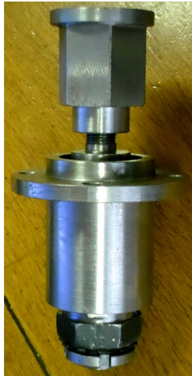
Rys. 19. Ułożyskowana piasta, za pomocą której mocowana jest wewnętrzna płyta przyrządu. Widoczna jest również nakrętka łącząca piastę z osią piasty koła badanego pojazdu.
