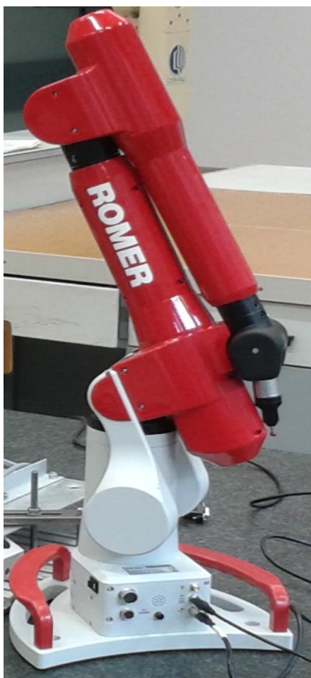
Rys. 25. Ramię pomiarowe firmy ROMER Multi Gage, za pomocą którego wyznaczone zostały współrzędne punktów H_i dla i=1(9) . a) Widok ogólny. b) Zbliżenie na końcówkę pomiarową.
