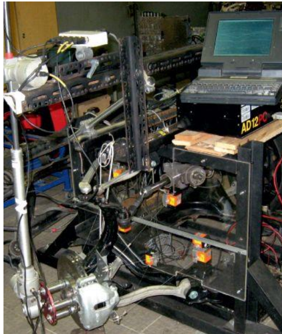
Rys. 7. Przyrząd do pomiaru translacji i rotacji koła kierowanego samochodu osobowego zamocowany na stanowisku pomiarowym [5], [8].
