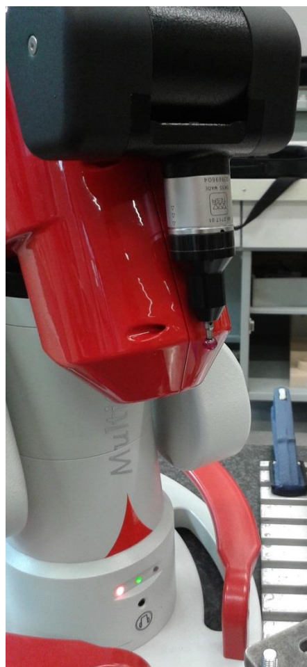
Rys. 25. Ramię pomiarowe firmy ROMER Multi Gage, za pomocą którego wyznaczone zostały współrzędne punktów H_i dla i=1(9) . a) Widok ogólny. b) Zbliżenie na końcówkę pomiarową.
