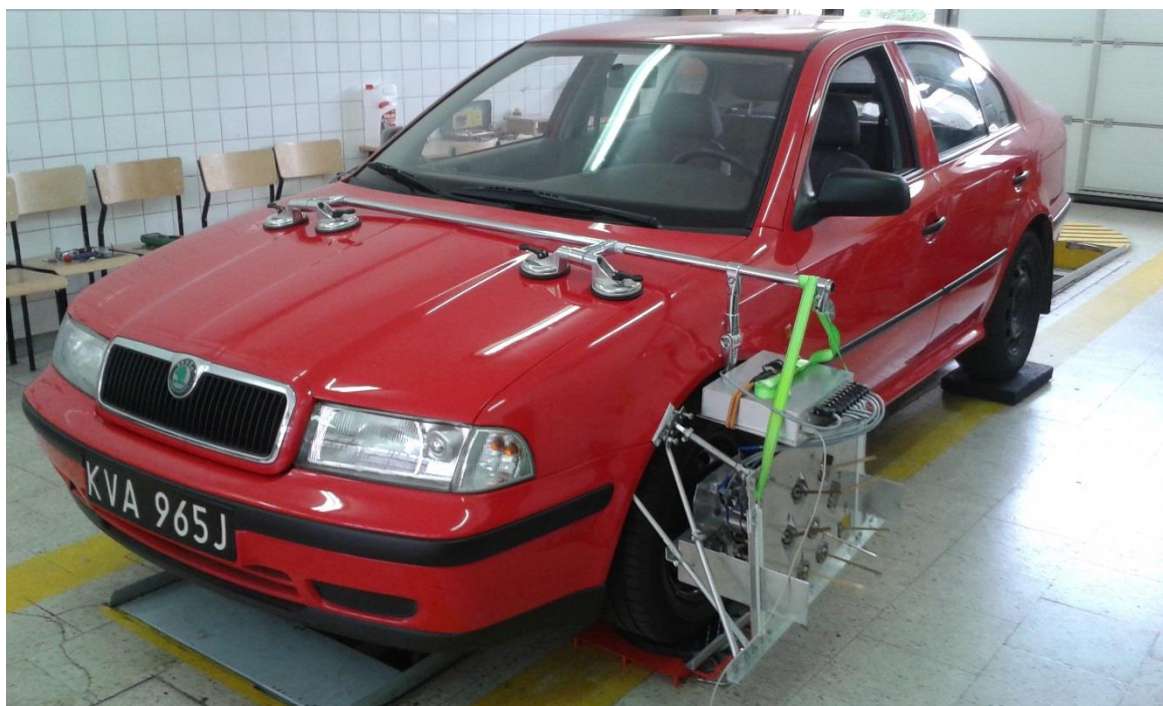
Rys. 33. Widok ogólny pojazdu z zamocowanym prototypowym przyrządem pomiarowym. Widoczne obrotnice pod kołami osi przedniej oraz odpowiedniej wysokości płyty pod kołami osi tylnej.
