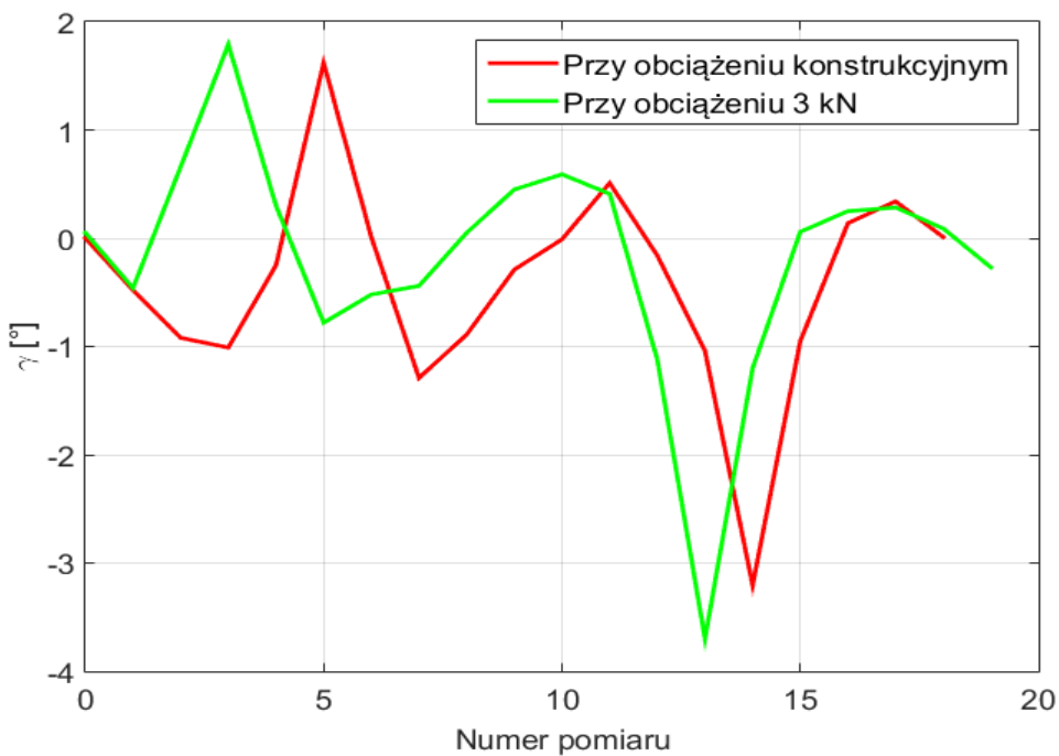
Rys. 89. Kąt pochylenia \gamma lewego koła samochodu Skoda Octavia I, wyznaczony za pomocą prototypowego przyrządu pomiarowego, w funkcji kolejnych kroków pomiaru dla różnych ugięć zawieszenia.
