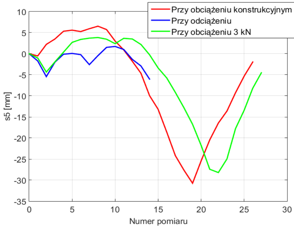
Rys. 120. Zmiany wydłużeń, związanego z punktem D_3 , łącznika s_5 prototypowego przyrządu pomiarowego w funkcji kolejnych kroków pomiaru dla różnych ugięć zawieszenia.
