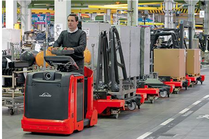
Rys. 3.3 Kosz do kompletacji kilku zamówień (a), pociąg logistyczny (b)
