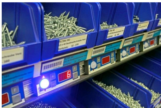
Rys. 3.7 System pick by light, wskazanie miejsca oraz liczby sztuk do pobrania
