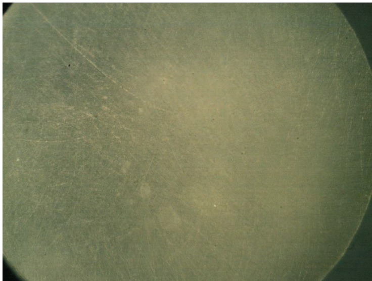
Rys. 65. Powierzchnia kompozytu napełnianego BaTiO 3 . Zdjęcie wykonano przy użyciu mikroskopu optycznego
