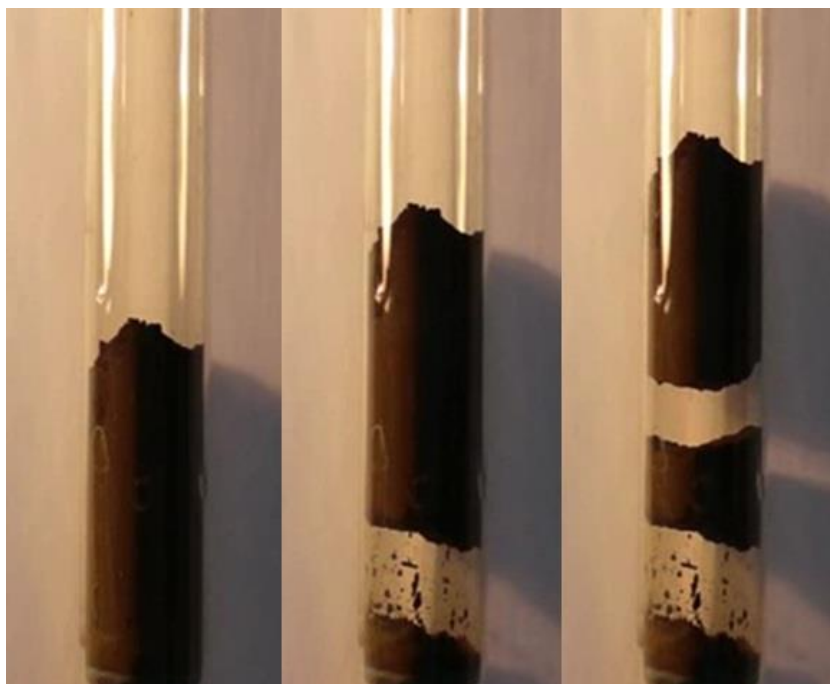
a) tłokowanie zaobserwowane podczas próby fluidyzacji pyłu katalizatora pobranego z linii produkcyjnej tuż przed pastylkowaniem
