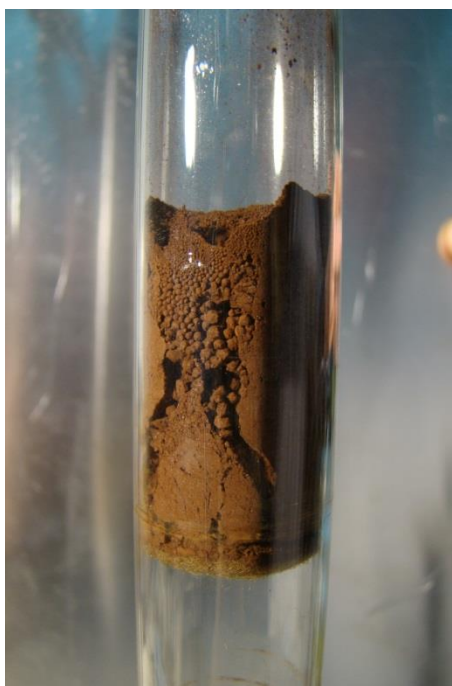
b) kanałowanie złoża połączone z aglomeracją ziaren podczas próby fluidyzacji katalizatora żelazowo-chromowego TZC-3/1 o wielkości ziaren 0-120 \mu\text{m}
