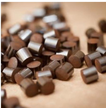
Rysunek 5. Katalizator żelazowo-chromowy TZC-3/1
