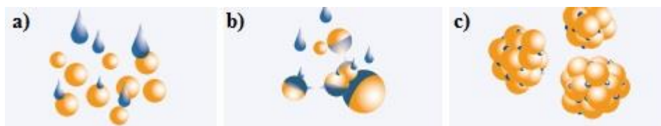
Rysunek 12. Schemat procesu granulowania w złożu fluidalnym
