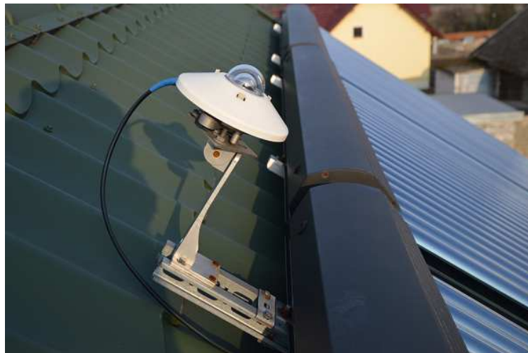
Rys. 3.18. Zdjęcie pyranometru CM 21 zamontowanego w pobliżu kolektorów słonecznych
