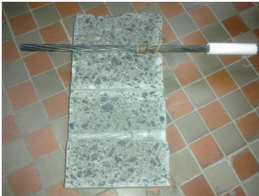
Rys. 7.17 Widok obu części betonowej próbki po rozłupaniu
