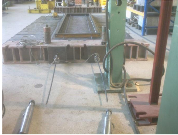
Rys. 9.35 Przygotowana forma z ceowników z naciągniętymi splotami sprężającymi
