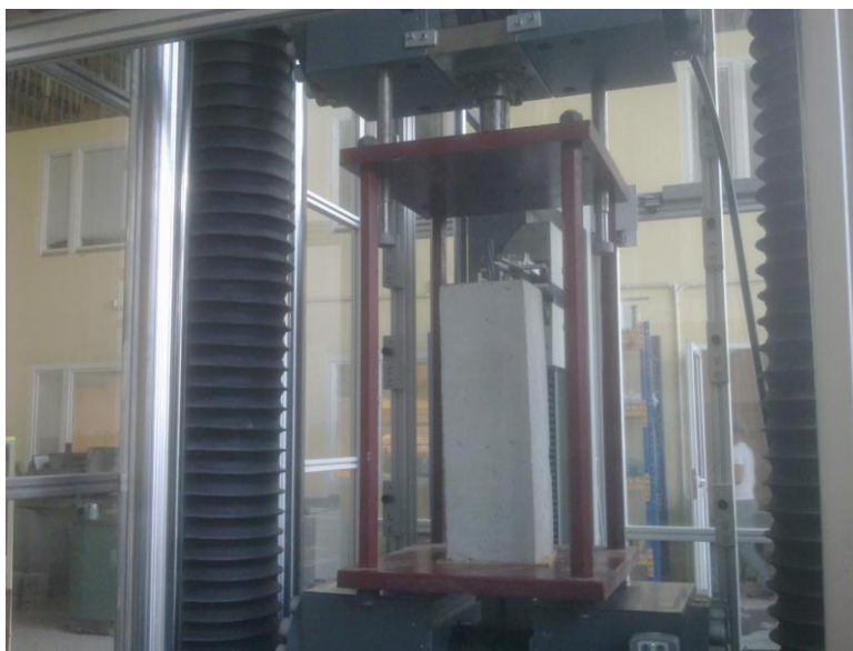
Rys. 7.16 Widok próbki o czynnej długości przyczepności 460 mm na stanowisku badawczym
