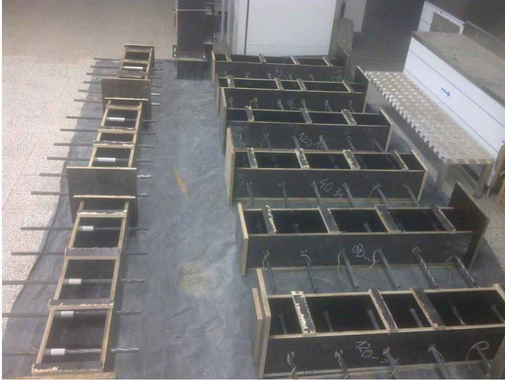
Rys. 7.4 Próbki przygotowane do betonowania w fazie I
