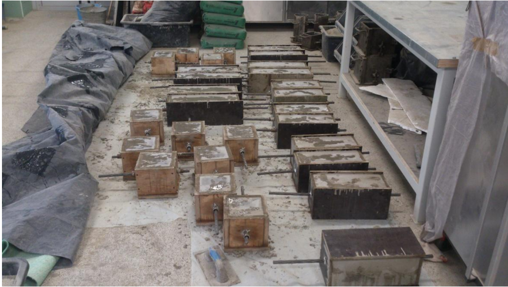
Rys. 7.14 Próbkę po betonowaniu w fazie zasadniczej
