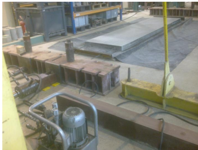
Rys. 9.38 Zwolnienie naciągu siły sprężającej
