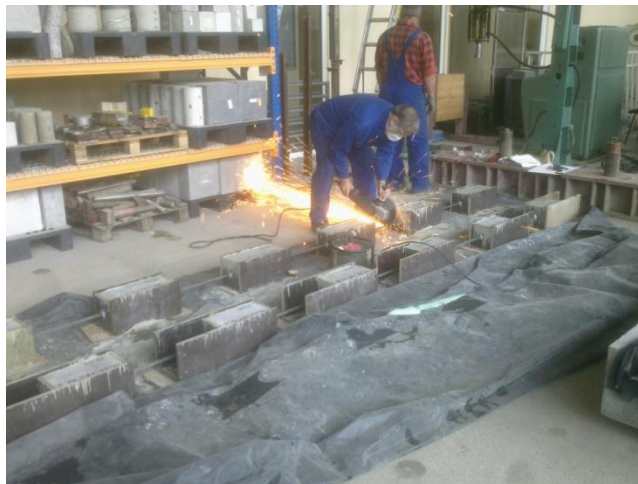
Rys. 7.35 Próbki po betonowaniu następnego dnia, przed zwolnieniem naciągu
