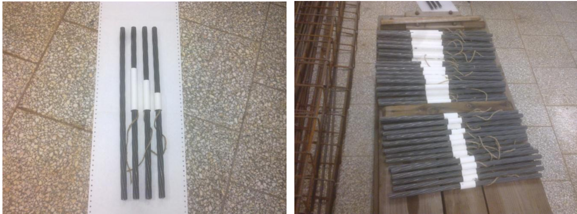
Rys. 7.2 Przygotowane próbki z nawiniętym sznurkiem konopnym
