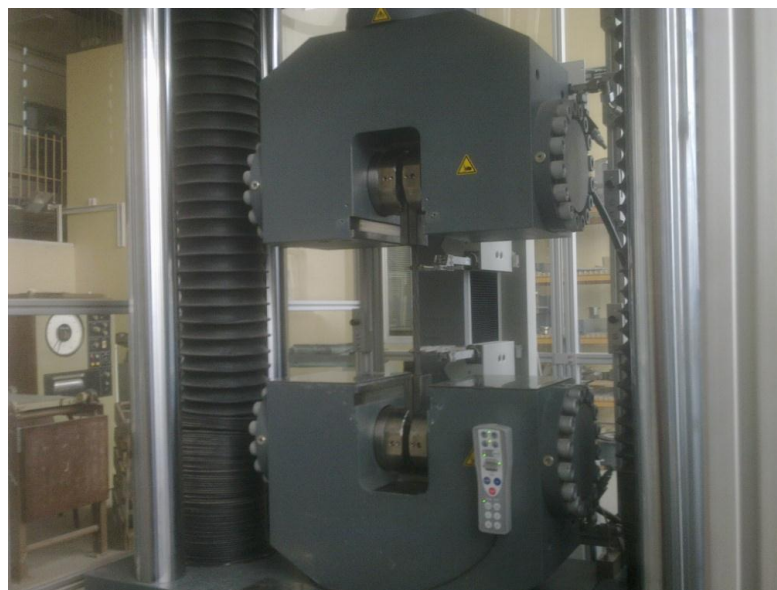
Rys. 5.4 Badanie splotów w maszynie Zwick-Roell Z1200
