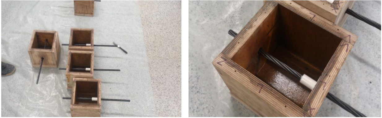
Rys. 7.30 Formy wykorzystane podczas wytwarzania próbek z widocznym splotem zaopatrzonym w tulejkę plastikową
