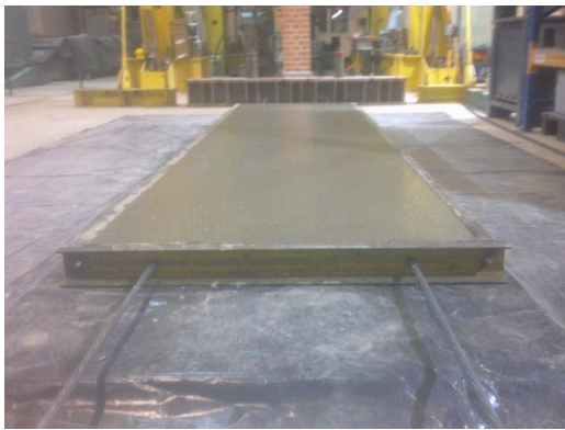
Rys. 9.36 Płyta po zabetonowaniu i podczas pielęgnacji
