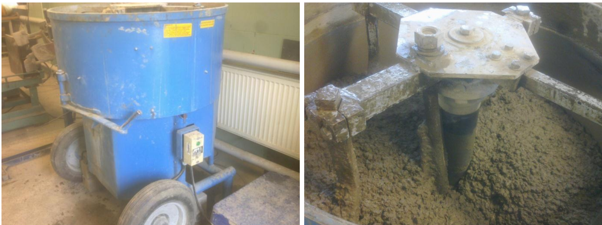
Rys. 7.12 Widok mieszalnika (po lewej) i mieszanka betonowa w trakcie wytwarzania (po prawej).
