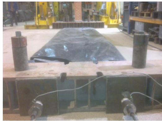
Rys. 9.35 Przygotowana forma z ceowników z naciągniętymi splotami sprężającymi
