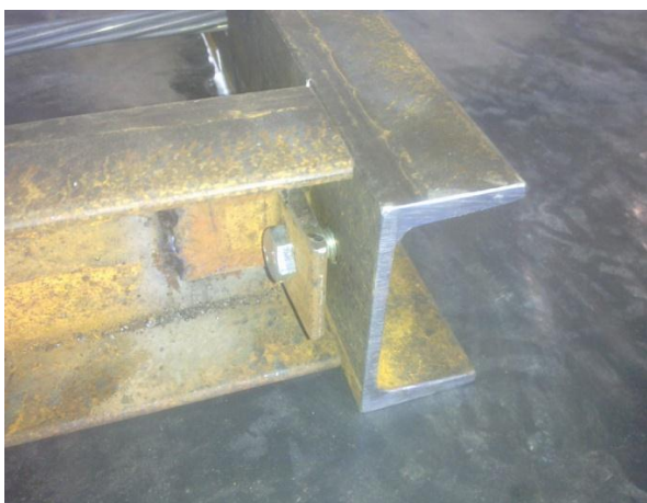
Rys. 9.33 Szczegół połączenia naroża (po lewej) i widok stalowej formy z przeciągniętymi splotami (po prawej)
