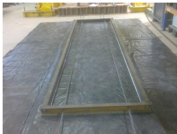
Rys. 9.33 Szczegół połączenia naroża (po lewej) i widok stalowej formy z przeciągniętymi splotami (po prawej)
