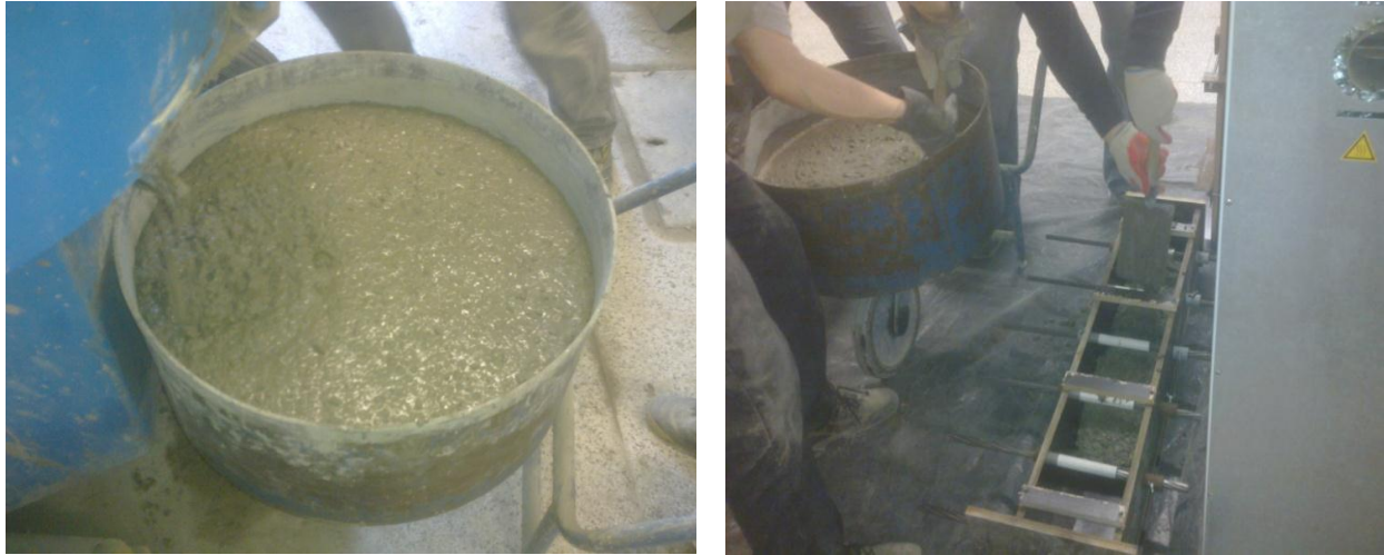
Rys. 7.13 Mieszanka betonowa bezpośrednio przed betonowaniem (po lewej) i układanie betonu w próbkach (po prawej)
