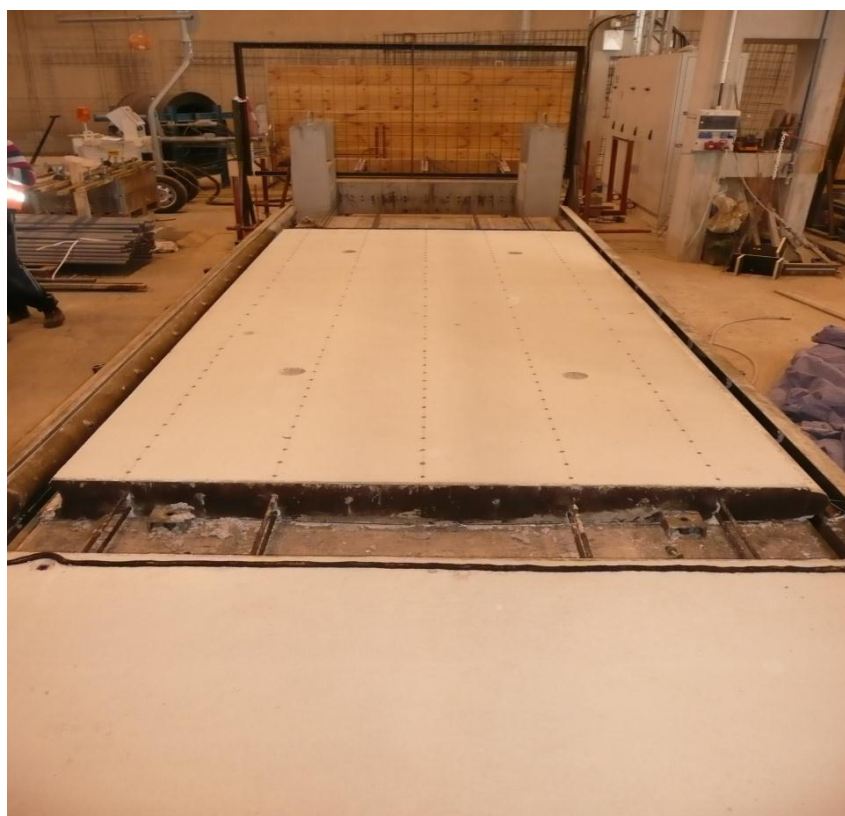
Rys. 9.5 Ogólny widok prefabrykowanej płyty i rozmieszczenie punktów pomiarowych
