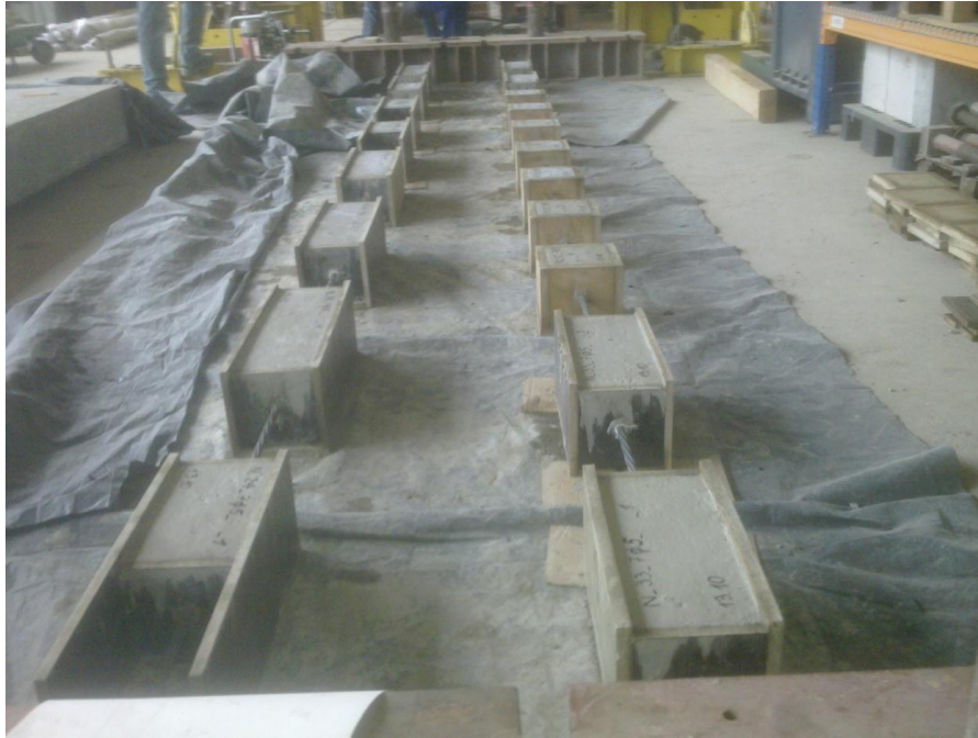
Rys. 7.35 Próbki po betonowaniu następnego dnia, przed zwolnieniem naciągu
