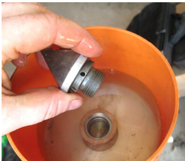
Fot. Z2.4. Procedura instalacji filtra porowatego bezpośrednio za stożkiem (fot. B. Czado)
