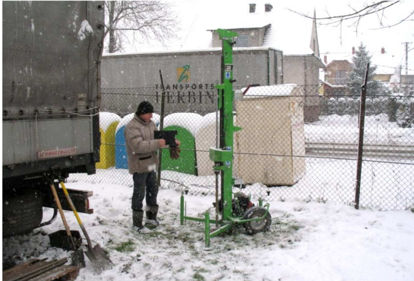
Fot. Z2.3. Badania sondą dynamiczną (fot. B. Czado)
