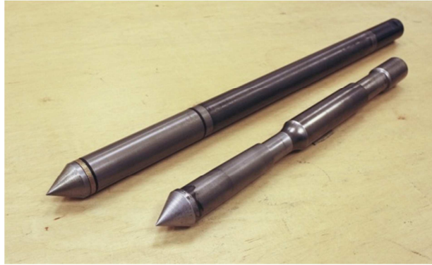
Fot. 3.1. Stożki sondy statycznej: elektryczny S-CPTU (z lewej) i mechaniczny CPTM (z prawej) na wyposażeniu Zakładu Współdziałania Budowli z Podłożem, PK (fot. B. Czado)
