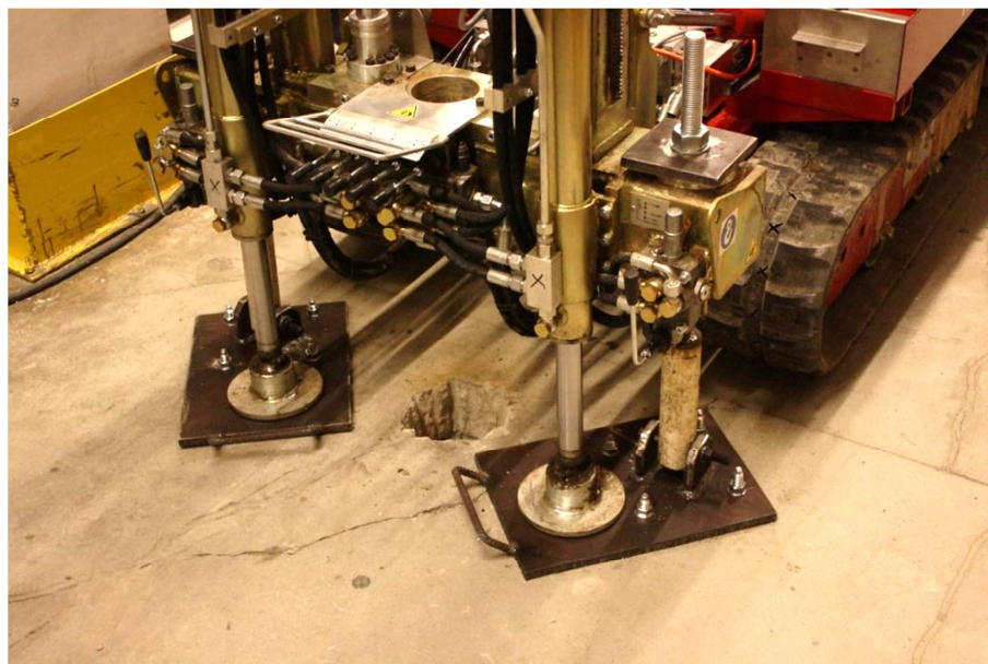
Fot. Z2.5. Rozwiązanie własne zakotwienia sondy w posadzce (fot. B. Czado)
