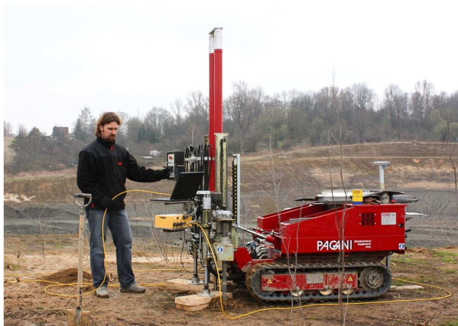
Fot. Z2.2. Realizacja badań sondą statyczną samobieżną PAGANI TG 63-150 na poligonie badawczym w Zesławicach (fot. arch. autora)
