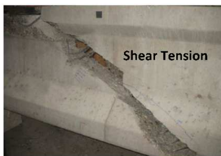
Rys. 3.10. Zniszczenie od uplastycznienia zbrojenia poprzecznego [92]
