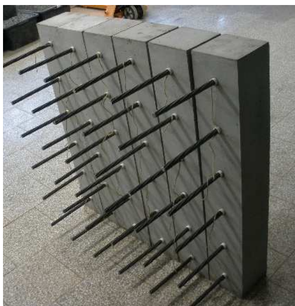
Rys. 7.17. Gotowe elementy słupkowe – typu III
