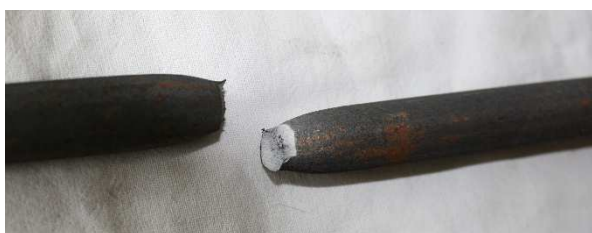
Rys. 6.27. Osłabienie przekroju w miejscu zerwania
