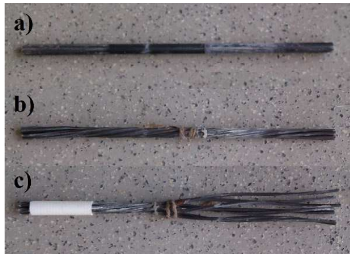
Rys. 7.23. Wyciągnięte zbrojenie po badaniach: a) pręt gładki \phi 16 mm, b) splot sprężający 7\phi 5 mm, c) rozpleciony splot – drugi mechanizm zniszczenia dla splotów
