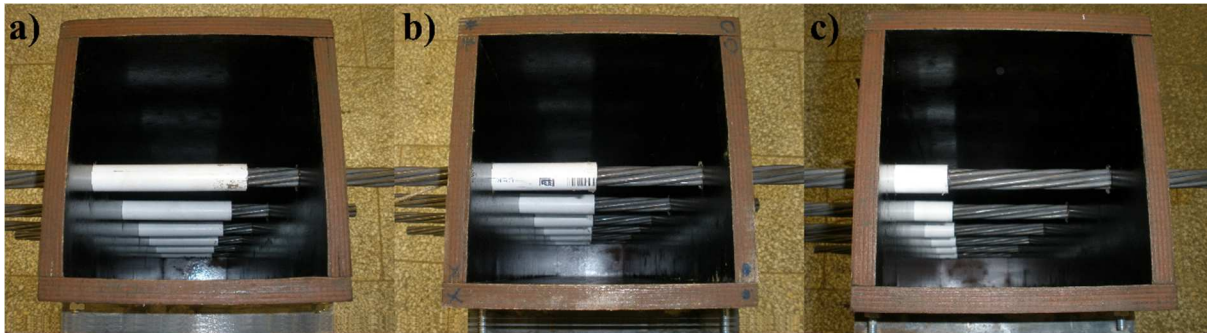
Rys. 7.5. Zamontowane sploty przy różnych długościach czynnych: a) 40 mm, b) 80 mm, c) 120 mm
