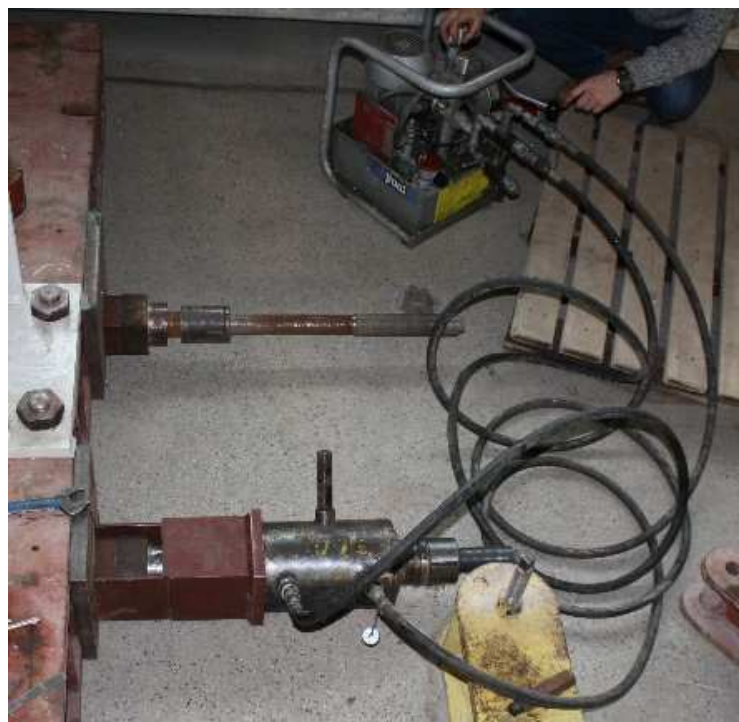
Rys. 7.19. Rozkotwianie zakotwień gwintowanych na torze – sprężanie próbek
