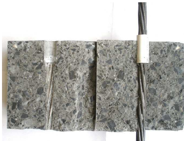
Rys. 7.25. Rozłupana próbka ze splotem siedmiodrutowym 7\phi 5 mm o długości czynnej 120 mm
