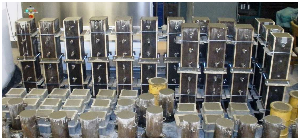
Rys. 7.14. Zabetonowane elementy próbne typu II w jednym z betonowań
