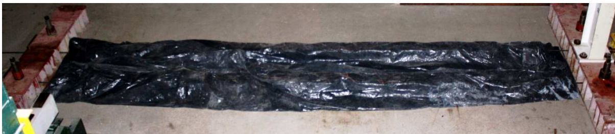
Rys. 7.16. Zabezpieczony tor przed odparowywaniem wody – widok z góry (zdjęcie w nocy)
