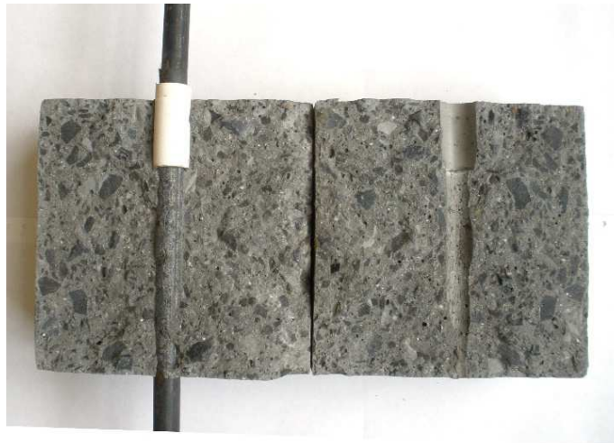
Rys. 7.24. Rozłupana próbka z prętem gładkim \phi 16 mm o długości czynnej 120 mm
