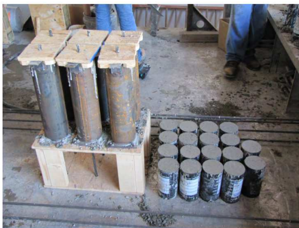
Rys. 5.21. Próbkki betonowe do testu NASP oraz cylindry do badania wytrzymałości na ściskanie [154]
