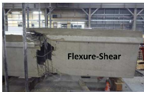
Rys. 3.7. Zniszczenie od ścinania przy współudziale zginania [96]
