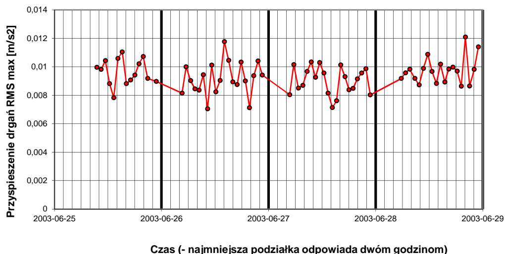
Rys.4.2.15. Wybrane dobowe rozkłady wartości RMSmax w budynku N118 podczas przejazdów pociągu 17
