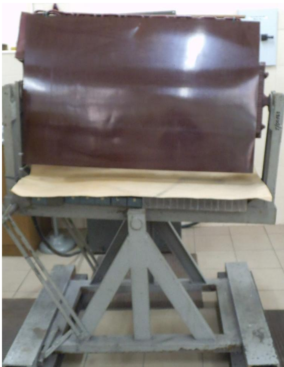
Rysunek IV-8. Laboratoryjny separator płytowy z biegnącym polem magnetycznym (trójfazowy).
