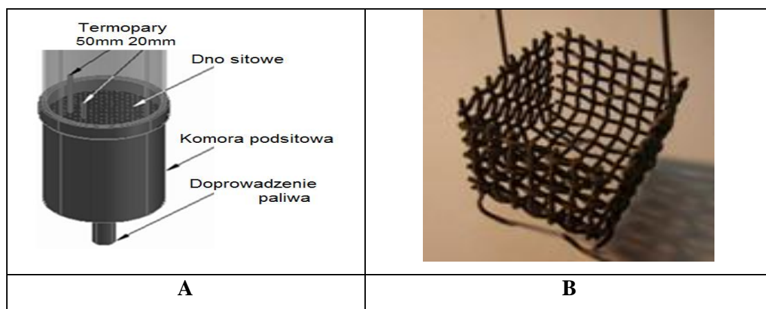
Rysunek IV-3. System doprowadzania paliw gazowych i pomiaru temperatury (A) oraz kosz żaroodporny (B).
