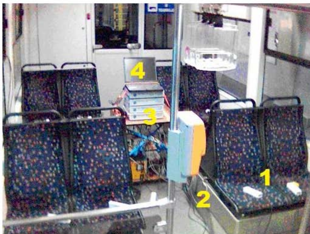
Rys. 7.2 Aparatura pomiarowa. 1 - Osobiste urządzenia oceny OUC, 2 - Czujniki przyspieszenia, 3 - Przetworniki A/C, 4 - Komputer z zasobami pamięci.
