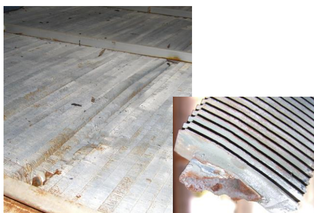
Rys. 2.14. Wyboczenie i pęknięcie ożebrowanych rurek eliptycznych wymiennika ciepła typu spaliny woda
