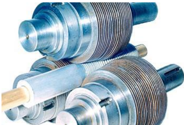
Rys. 2.5. Układ walców do rozwalcowywania rur
