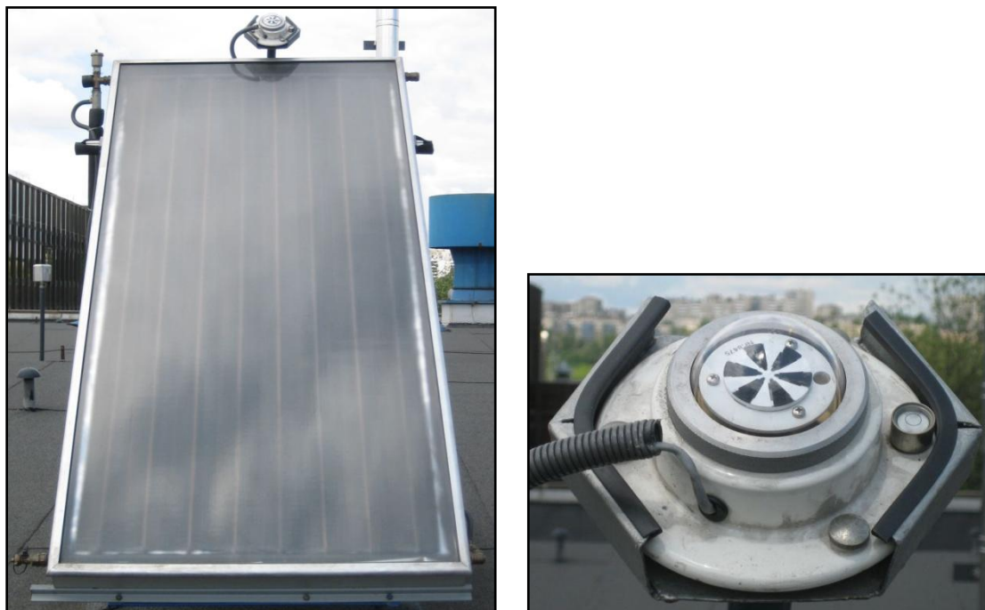
Rys. 6.2. Widok kolektora słonecznego „TOP” oraz zastosowanego piranometru FLA 6285 typ 8101
