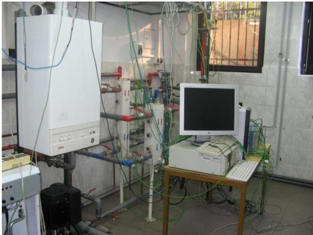
Rys. 35. Komputer stanowiska badawczego oraz system akwizycji danych ALMEMO 5590
