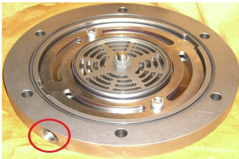
Rys. 6.12: Zawór koncentryczny z otworem umożliwiającym pomiar ciśnienia wewnątrz cylindra
