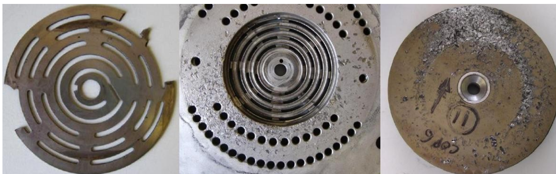
Rys. 6.10: Uszkodzenia elementów zaworu i tłoka w wyniku zaistniałych awarii
