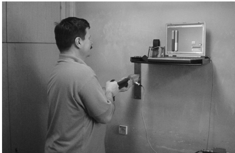
Rys. 4.2 Zdjęcie stanowiska z człowiekiem – operatorem oraz ręcznym narzędziem i przetwornikiem siły
