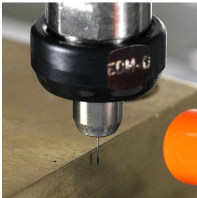
Rys. 42. Uchwyt z elektrodą zamontowany na stanowisku roboczym.
