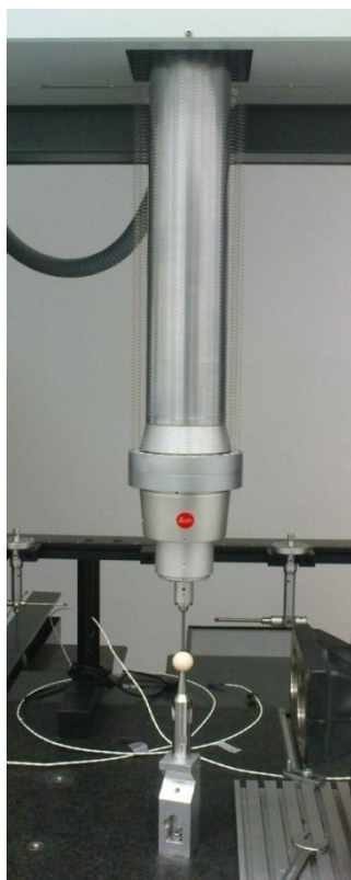
Rys. 63. Pomiary wzorca sferycznego zrealizowanego na maszynie typu PMM 12106 wyposażonej w głowicę mierzącą Leitz
