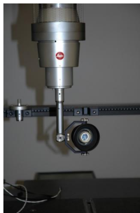
Rys. 57. Retroreflektor typu „kocie oko” zamontowany na maszynie pomiarowej
