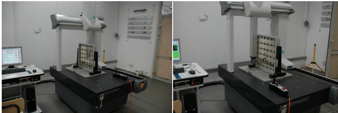
Rys. 37. Pomiary płyty otworowej w jednej z zalecanych pozycji na maszynie DEA Global
