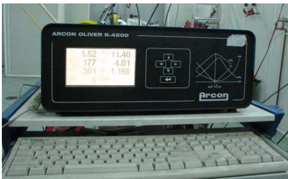
Rys. 5.2. Analizator spalin Arcon Oliver K-4500 na stanowisku badawczym.
