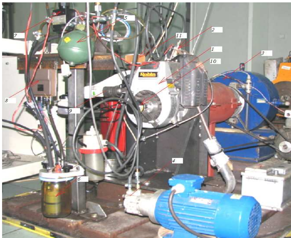
Rys.5.4. Widok stanowiska badawczego silnika z bezpośrednim wtryskiem paliwa
