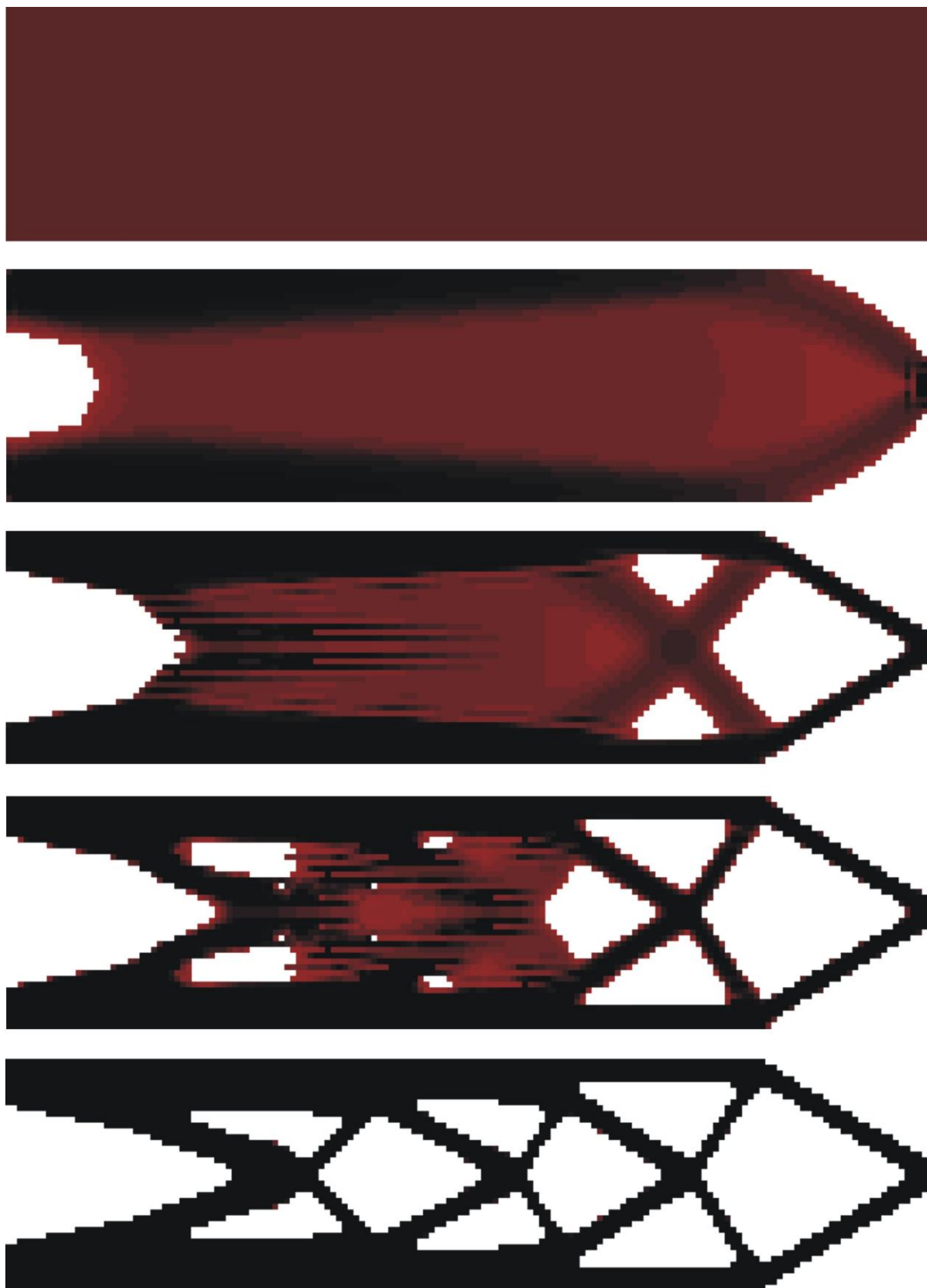
Rys. 6.25. Topologia początkowa, wybrane pośrednie (iteracje: 2, 8, 20, 27) oraz topologia wynikowa (iteracja 60) dla struktury przedstawionej na rys. 6.24. Udział objętościowy: \kappa = 0.5 , podatność dla otrzymanego rozwiązania: 362.9 Nmm. Zastosowano regułę II.
