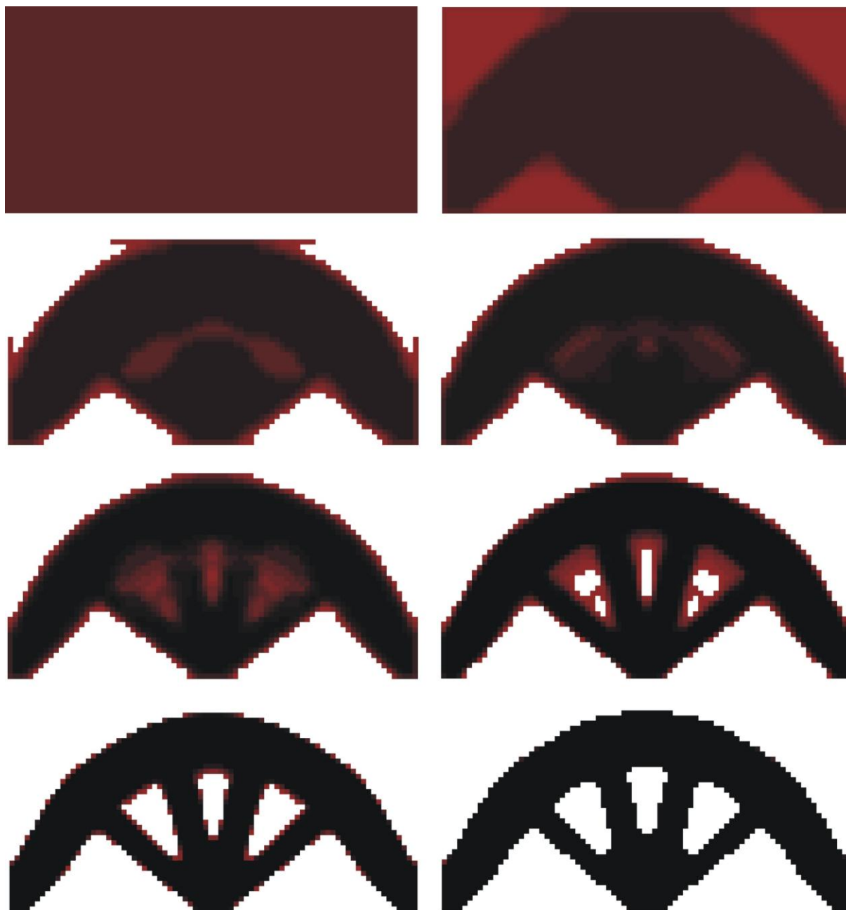
Rys. 7.2. Topologia początkowa, wybrane pośrednie (iteracje: 2, 4, 6, 8, 10, 12) oraz topologia wynikowa (iteracja 27) dla struktury przedstawionej na rys. 7.1. Udział objętościowy: \kappa = 0.5 , podatność dla otrzymanego rozwiązania: 9.83 Nmm. Zastosowano regułę I.
