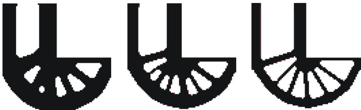
Rys. 7.4. Topologie odpowiadające maksymalnej sztywności otrzymane dla różnych udziałów objętościowych \kappa : \kappa = 0.375 , podatność 66.26 \text{ Nmm} (iteracja 40), \kappa = 0.300 , podatność: 77.15 \text{ Nmm} (iteracja 100), \kappa = 0.225 , podatność 96.86 \text{ Nmm} (iteracja 80)
