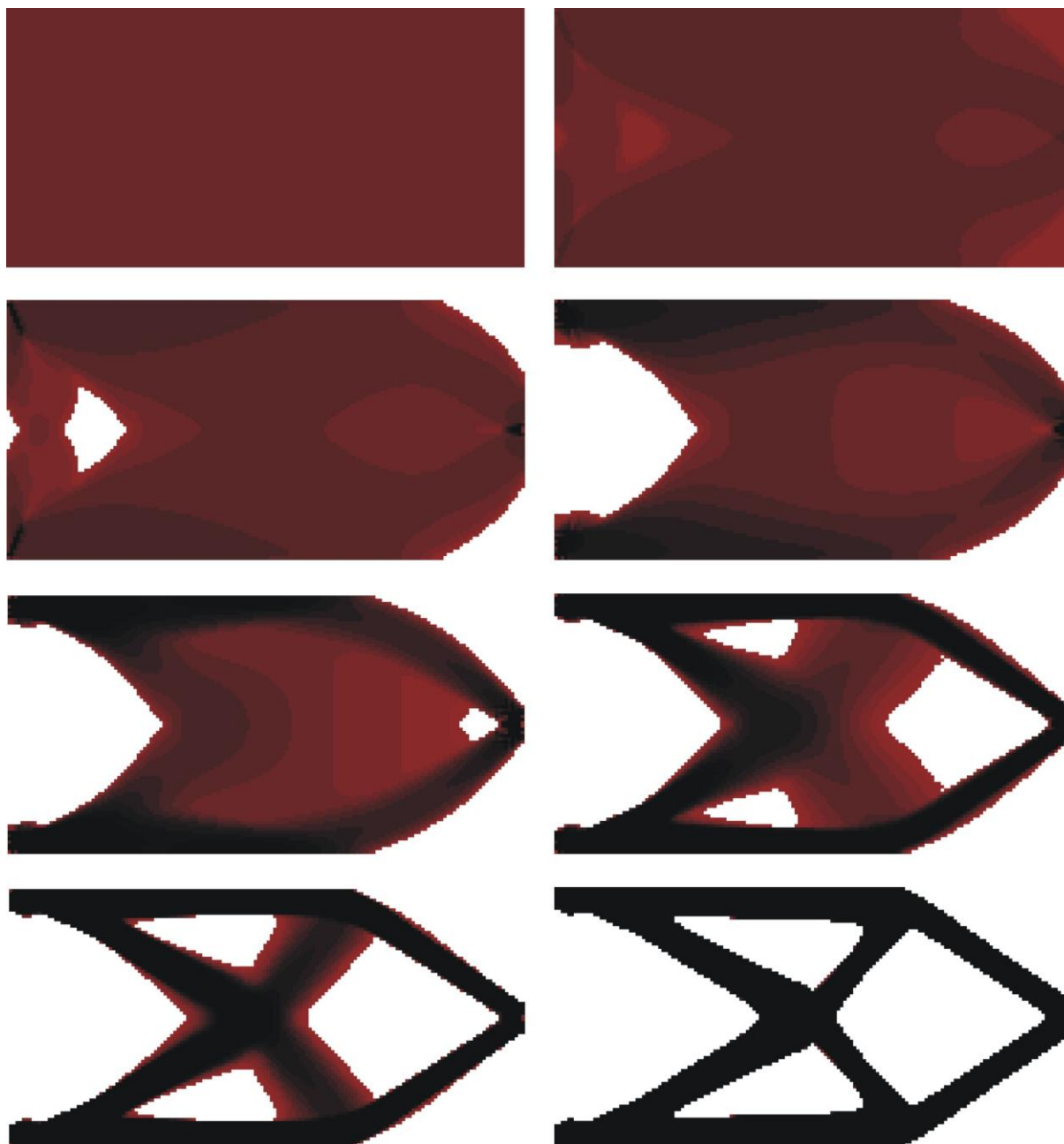
Rys. 6.11. Topologia początkowa, wybrane pośrednie (iteracje: 1, 3, 8, 13, 17, 19) oraz topologia wynikowa (iteracja 50) dla struktury przedstawionej na rys. 6.10. Udział objętościowy: \kappa = 0.4 , podatność dla otrzymanego rozwiązania: 112.2 Nmm. Zastosowano regułę II.
