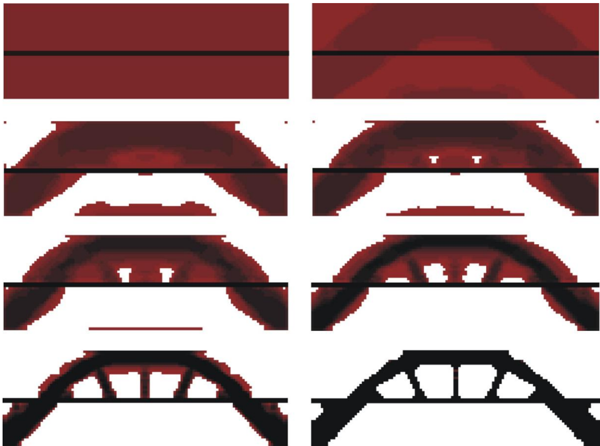
Rys. 7.9. Topologia początkowa, wybrane pośrednie (iteracje: 2, 4, 5, 6, 8, 12) oraz topologia wynikowa (iteracja 38) dla struktury przedstawionej na rys. 7.8. Udział objętościowy: \kappa = 0.25 , podatność dla otrzymanego rozwiązania: 11.25 \text{ Nmm} . Zastosowano regułę I.
