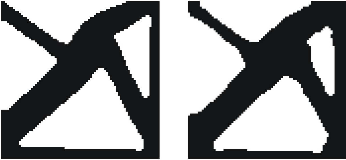
Rys. 7.42. Porównanie topologii dla dwóch ujęć problemu kształtowania. Po lewej ujęcie podatnościowe, po prawej naprężeniowe. Dla obu przypadków otrzymano takie same wartości podatności 1.28 \cdot 10^{-6} \text{ Nm}
