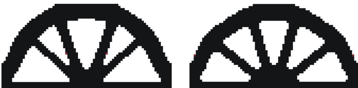
Rys. 6.5. Znalezione topologie, po lewej ujęcie klasyczne (45 iteracja, podatność 13.91), po prawej nowa propozycja, reguła I (28 iteracja, podatność 13.91)
