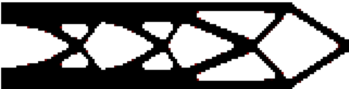
Rys. 6.27. Topologia wynikowa (iteracja 45) dla struktury przedstawionej na Rysunku 6.24. Podatność dla otrzymanego rozwiązania: 367.6 Nmm. Zastosowano regułę I
