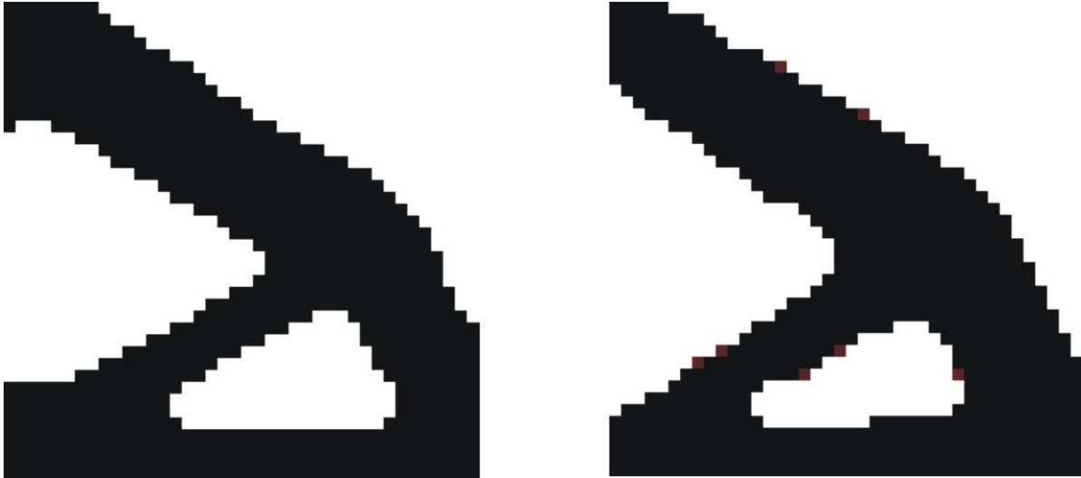
Rys. 7.35. Porównanie topologii dla dwóch ujęć problemu kształtowania. Po lewej ujęcie podatnościowe, po prawej naprężeniowe. Dla obu przypadków otrzymano takie same wartości podatności 1.04 \cdot 10^{-6} \text{ Nm}
