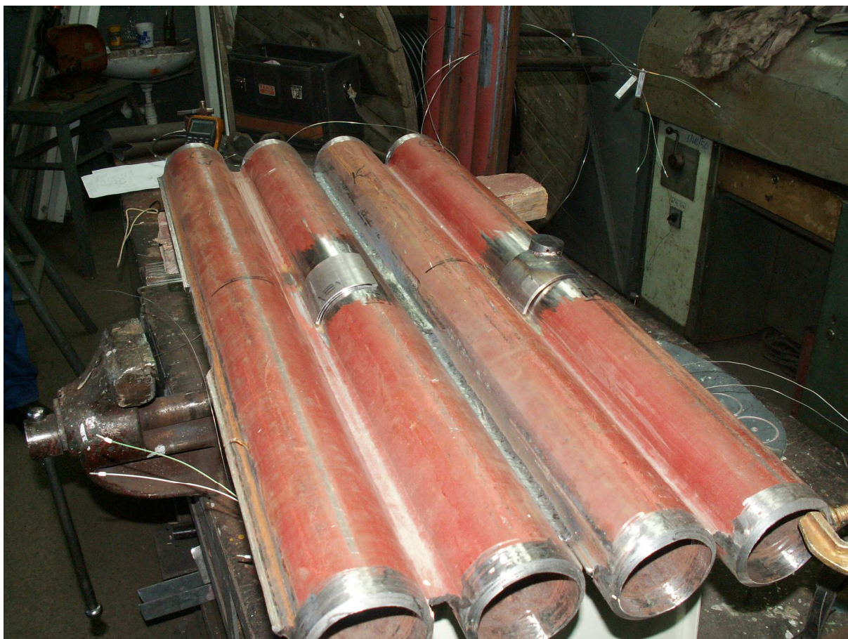
Rys. 3.12. Układ pomiarowy przygotowany do montażu w kotle – po lewej stronie znajduje się wstawka termometryczna, a po prawej miernik Gardona.
