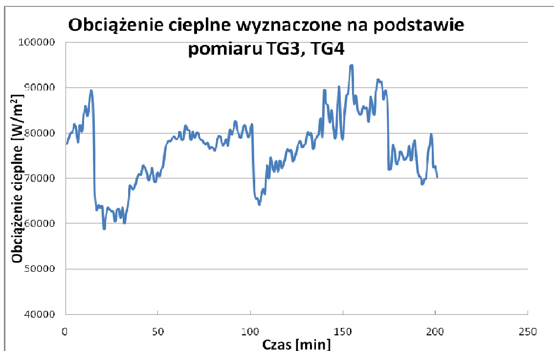
Rys. 7.10. Obciążenie cieplne wyznaczone q_m [W/m 2 ] wyznaczone na podstawie pomiaru temperatury miernikiem Gardona – pomiary w punktach TG3, TG4 – okres pomiaru 200 minut.
