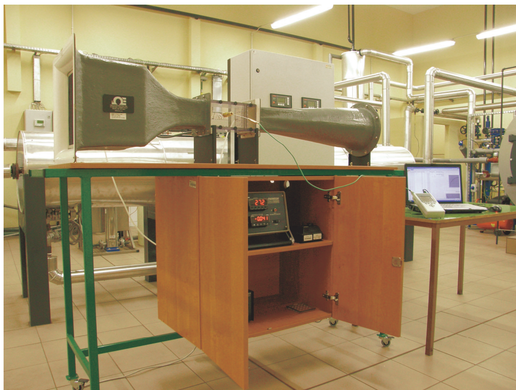
Rys. 8.1 Otwarty tunel powietrzny wykorzystany do określenia stałych czasowych termometrów
