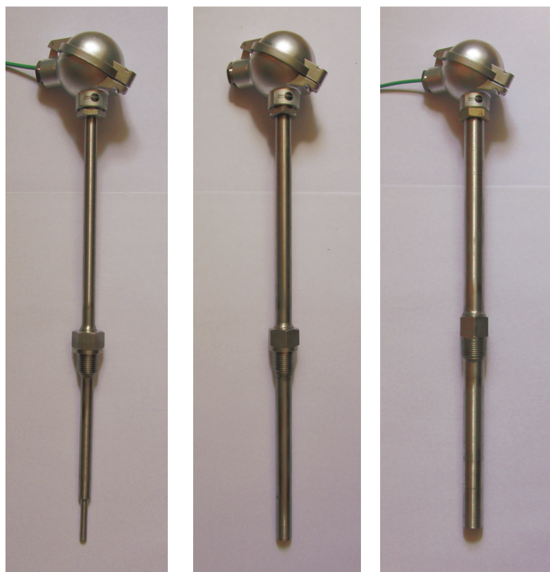
Rys. 9.1. Termoelementy w masywnych osłonach o średnicach (od lewej): 7 mm, 15 mm i 20 mm
