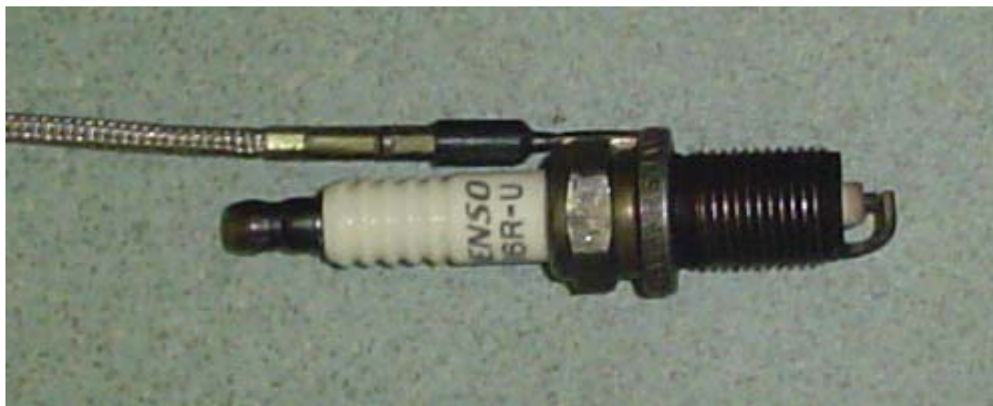
Rys. 3.8. Świeca zapłonowa z zamontowanym optoelektronicznym czujnikiem ciśnienia firmy Optrand
