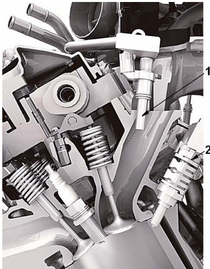
Rys. 1.7. Przekrój głowicy silnika 2GR-FSE [57]; 1- Wtryskiwacz układu wtrysku do przewodów dolotowych, 2 – Wtryskiwacz systemu wtrysku paliwa do cylindra.
