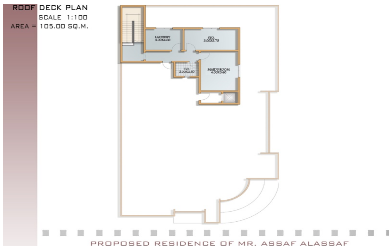
rys. 33. Układ funkcji zagospodarowania dachu. Funkcje tu lokalizowane związane są z obsługą techniczną i magazynową domu. Miejsce pełni też funkcję pokoi dla służby.
