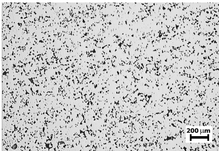
Rys. 12. Morfologia porowatości spieku Astaloy CrM bez dodatku boru po spiekaniu w temperaturze 1250^{\circ}C w atmosferze wodoru.
