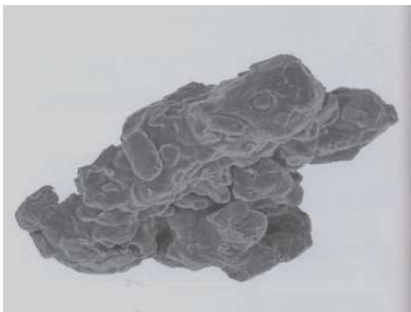
Rys.7. Zdjęcie SEM rozpylanego proszku Astaloy CrM [31].
