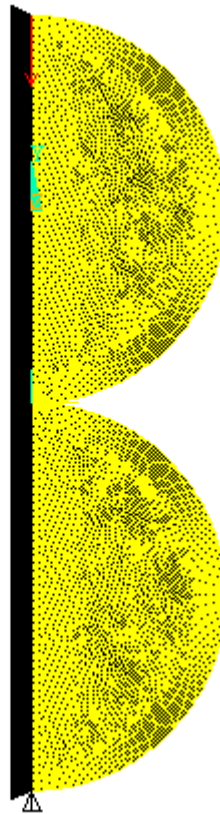
Rys.C.1.1 Model numeryczny oraz warunki brzegowe kontaktu dwóch kul.
