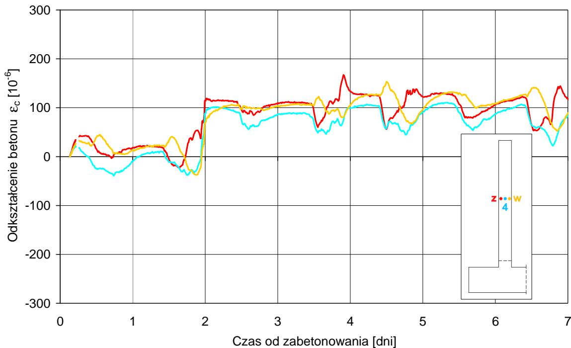
Rys. 5-28 Przebieg odkształceń betonu w przekroju ściany w okresie pierwszych 7 dni od zabetonowania na wysokości +1,62 m w warstwie środkowej oraz w warstwach na głębokości 50 mm od powierzchni zewnętrznej i wewnętrznej ściany.
