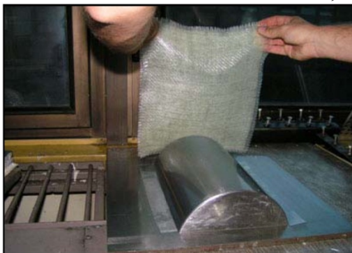
Rys. 5.6 Nakładanie laminatu na formę
