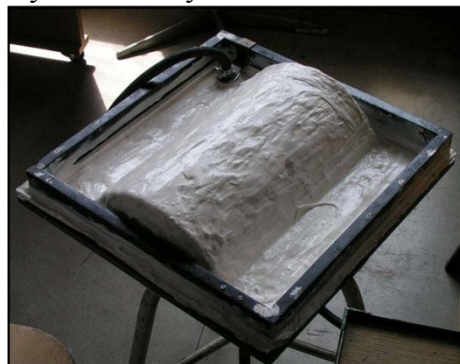
Rys. 5.7 Model w silikonowej formie z podłączoną pompą próżniową
