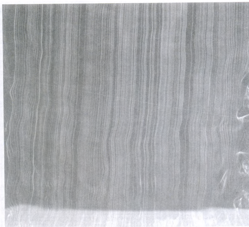
Rys. 75. Idealny przepływ laminarny w pomieszczeniu czystym, Charkowska (2000)
