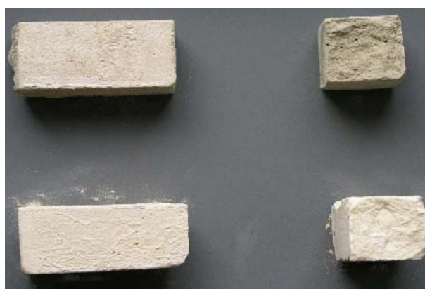
Rys.51. Próbka 5' mieszanki do podsadzki samozestalającej przed i po badaniu wymywalności substancji szkodliwych (właściwości próbek - tabele 25 i 26)
