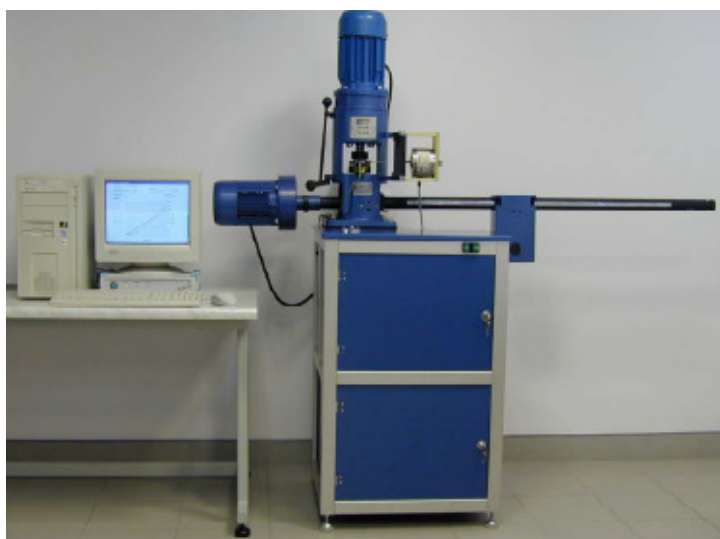
Rysunek 2.2.3.4. Wygląd stanowiska badawczego z aparatem czterokulowym T-02
