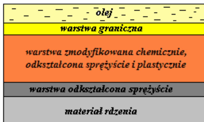
Rysunek 5.3.2.34. Graficzna prezentacja uogólnionego modelu warstwy wierzchniej stali modyfikowanej w warunkach tarcia mieszanego przez środek smarowy
