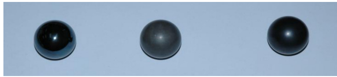
Rys.9.1. Kule wzorcowe z powłoką uzyskaną metodą: a) czernienia, b) chromowania, c) fosforyzowania
