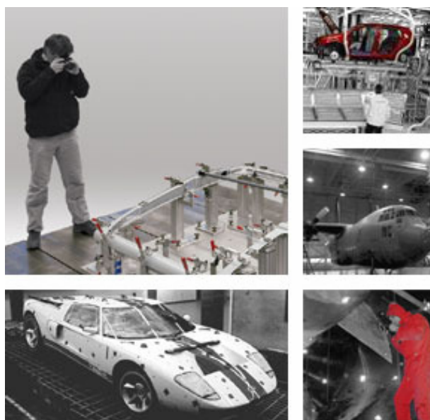
Rys.3.24. Pomiary przy zastosowaniu systemu TRITOP [82]
