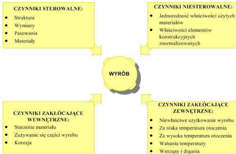
Rys.2. 17. Czynniki działające na wyrób – opracowanie własne na podstawie [Hamrol&Mantura 1999] [Phadke 1989]
