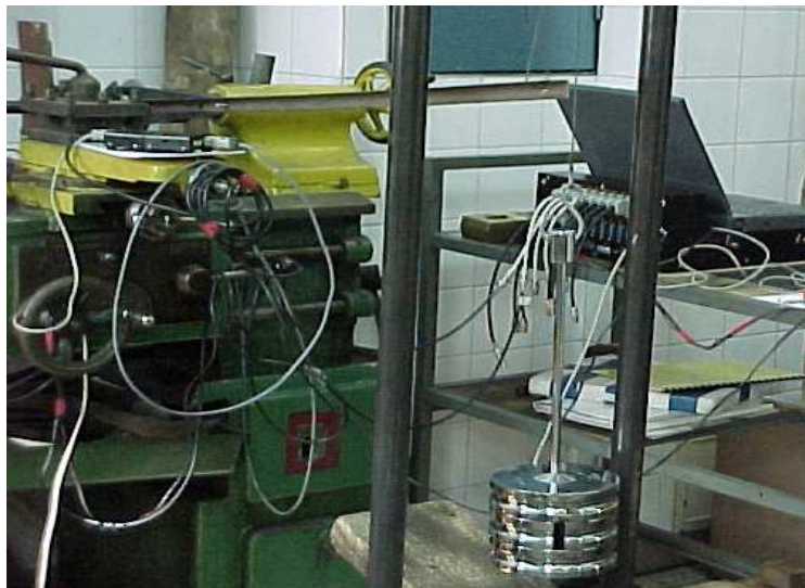
Rys. 6.9. Fragment stanowiska do badania sztywności półosi napędowych wraz z aparaturą do rejestracji wyników i układem dźwigniowym
