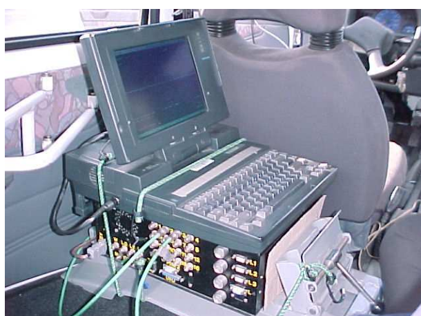
Rys.4.11 Układ przetwarzania, archiwizacji i wizualizacji danych AD-12
