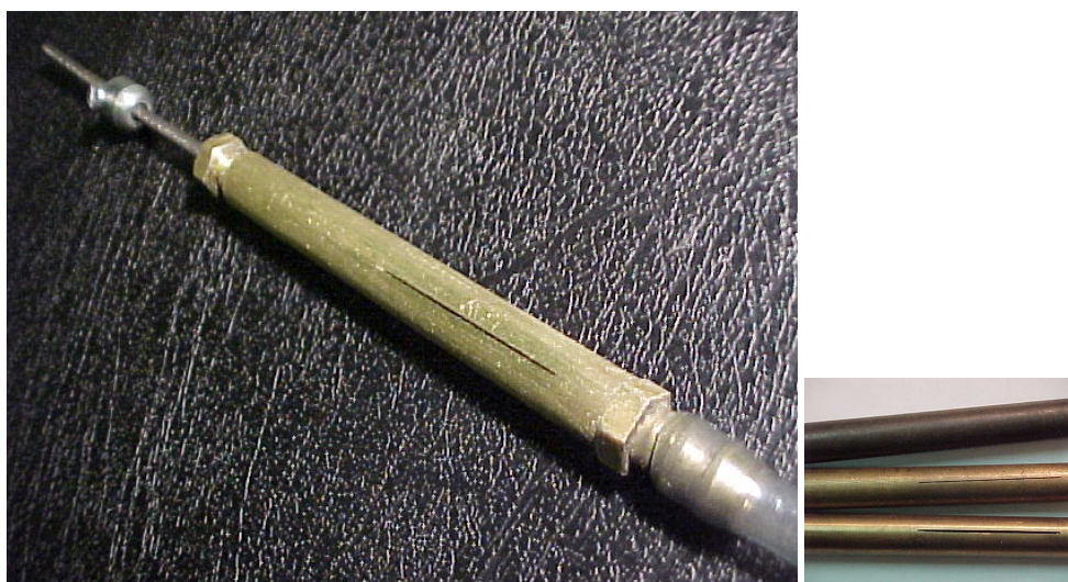
Rys. 4.15. Szczelinowy zawór pneumatyczny i badane szczeliny
