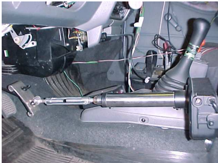
Rys. 4.9 „Mechaniczna noga” do sterowania pedałem gazu zamontowana w samochodzie badawczym.
