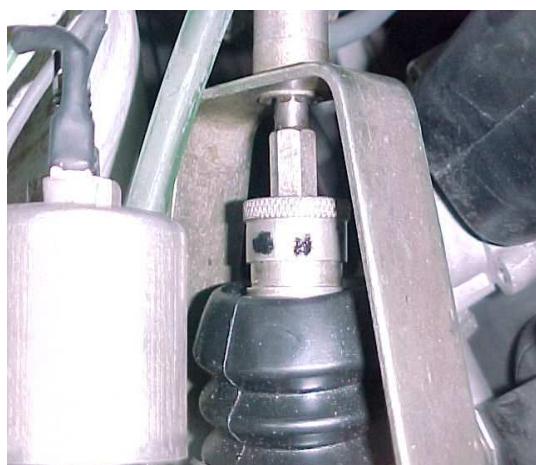
Rys. 4.10 Nakrętka regulacyjna; ustawienie: 0 obrotów wkręcenia
