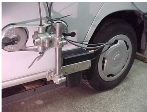
Rys.4.6. Głowica Correvit zamocowana do nadwozia samochodu.
