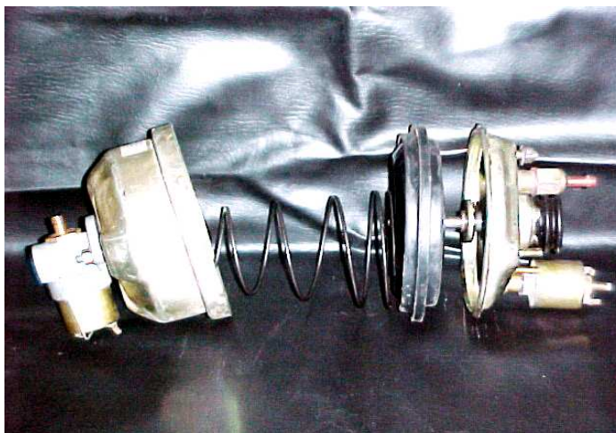
Rys.2.2 Otwarty siłownik wraz z zaworami automatu sprzęgłowego produkcji krajowej
