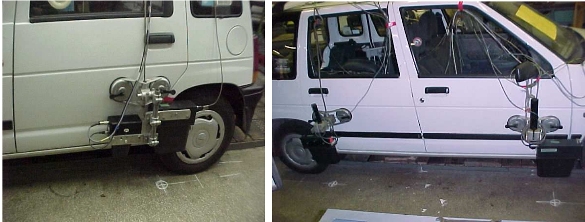
Rys.4.19. Ustawienie głowic Correvit Htl, Htp i Hpp – wyznaczanie kąta przechyłu wzdłużnego
